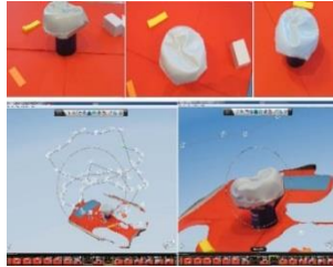
(ب) الاختبارات الأولى للمسح ثلاثي الأبعاد كجزء من سير العمل المستخدم لتطوير تصميم القبة لمشروع محمية لأكوتا الهندية.
