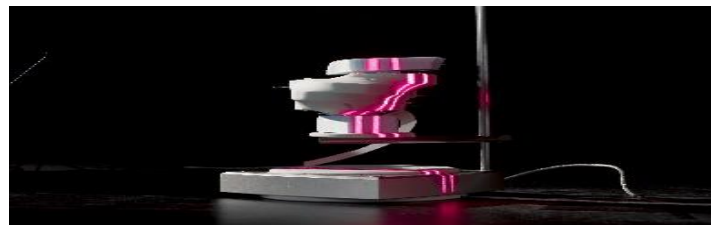
الشكل (17) المسح ثلاثي الأبعاد باستخدام شعاع الليزر للنموذج المادي لمشروع Paneum بيت الخبز. المصدر (موقع المكتب https://coop-himmelblau.at )
