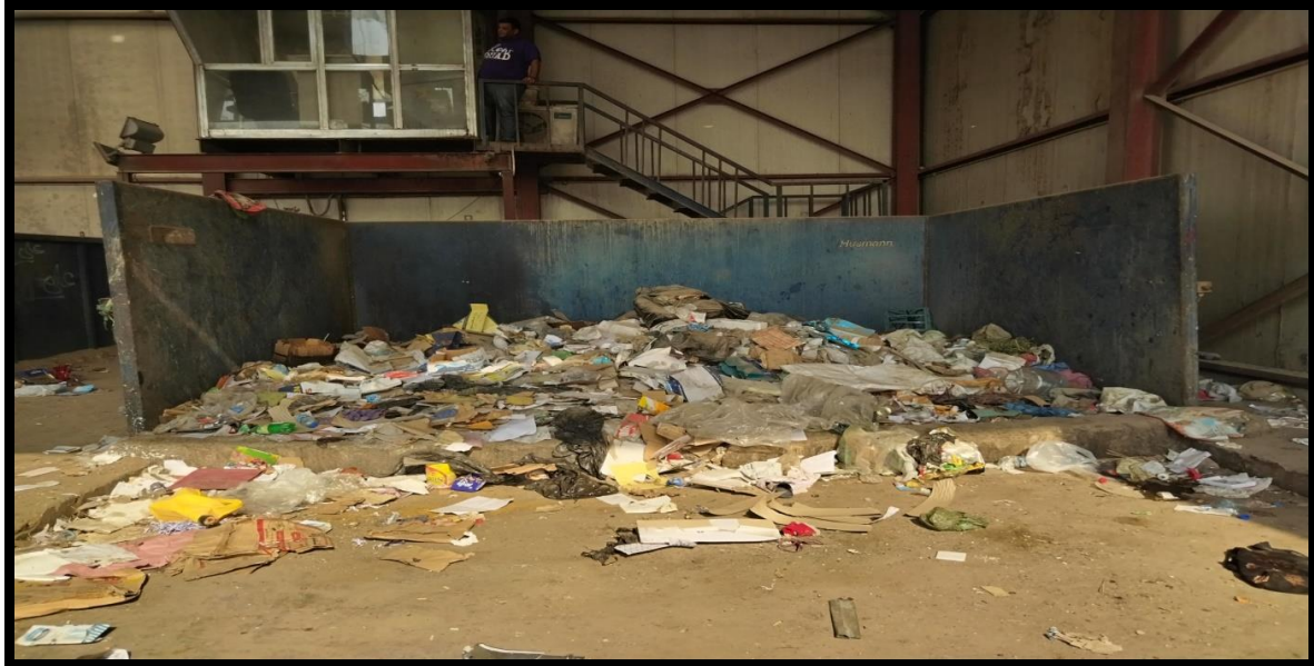
شكل (٨) (الهوبر) الثانوي (الصغير) للمكبس للمحطة التحويلية لبلدية الكرادة وهو ممتلئ بالنفايات وتناثرها حوله المصدر : الباحثين الدراسة الميدانية، ٢٠٢٢
