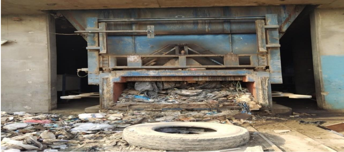
شكل (٥) المكبس الثانوي (الصغير) وهو ممتلئ بالنفايات لعدة ايام وانتشار النفايات حوله المصدر : الباحثين الدراسة الميدانية ، ٢٠٢٢
