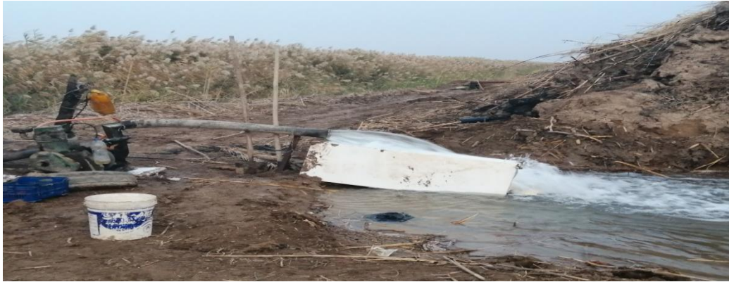
الصورة(٥) توضيح مضخة ماء تعمل بالكاز على قناة أروائية
