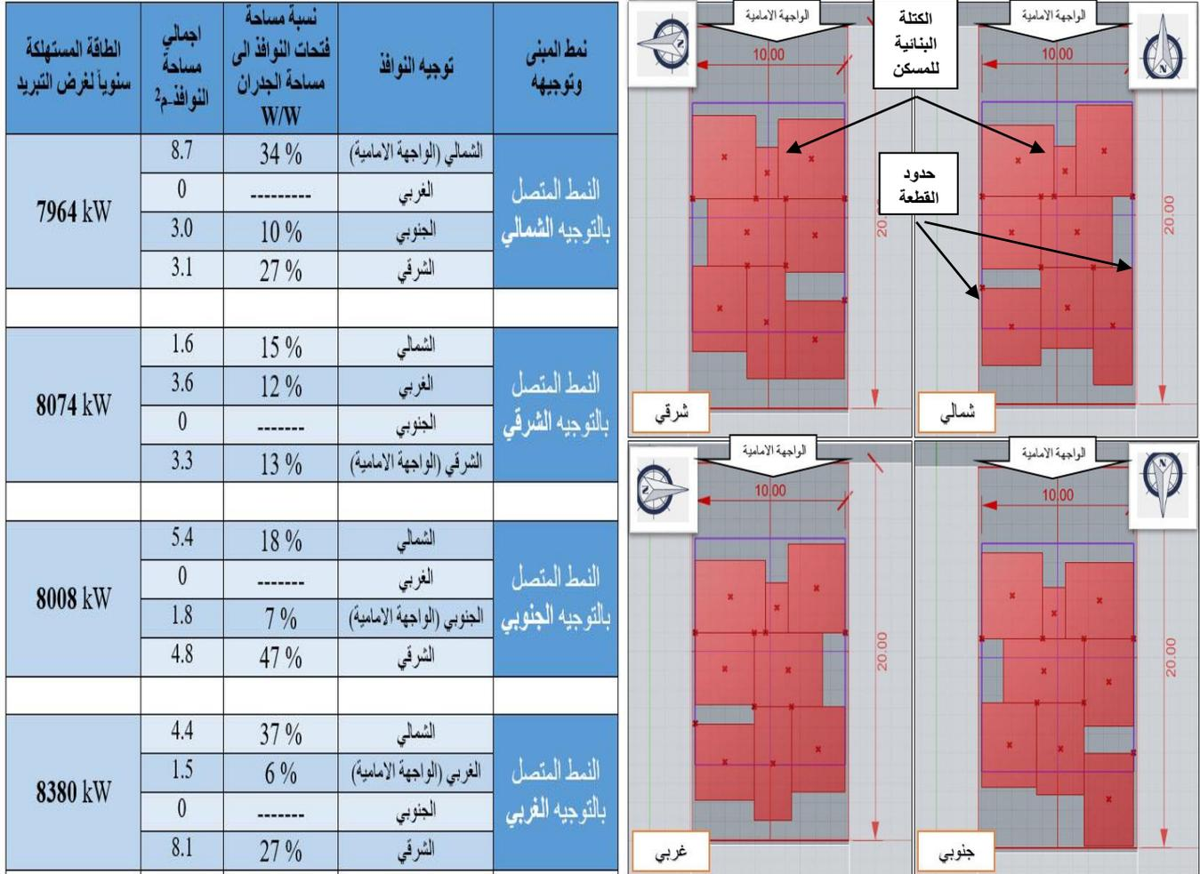
الشكل (11-1): النماذج الاكفأ التي تم التوصل لها بعملية تحسين الخصائص التصميمية (الشكل والابعاد ونسبة النوافذ) لكل توجيه لنمط المسكن المتصل.
